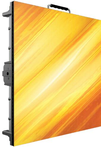
**DeltaPix 29B** è un LED screen da rental per l'uso indoor, con un pixel pitch di 2,9 mm, progettato per soddisfare le richieste di aziende, studi televisivi e installazioni. I pannelli del **DeltaPix 29B** possono essere curvati fino a creare un angolo concavo di 10° e supportano il backup automatico dell'alimentazione in caso di malfunzionamento dell'alimentatore. I componenti elettronici includono la receiver card di ultima generazione Novastar A5s con refresh rate fino a 3.840 Hz.
