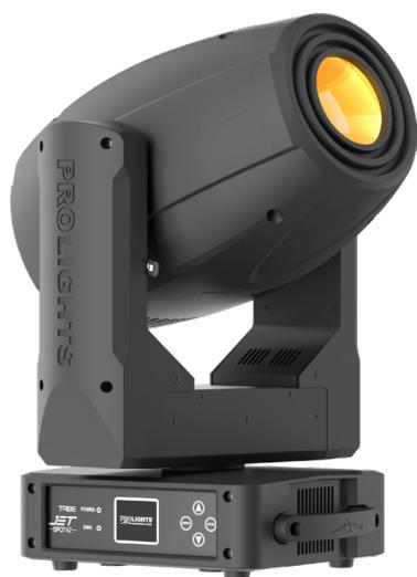
Jet Spot4Z è una testa mobile spot LED con sorgente 180W 6.800 K, progettato per sostituire un proiettore a scarica da 700W all'interno di teatri, sale da concerto e altre venues. Le sue dimensioni compatte consentono l'utilizzo in locali con soffitti bassi senza rinunciare allo zoom. Il suo sistema ottico offre un output costante con una proiezione nitida e uniforme dei gobo su tutta l'escursione dello zoom da 8° a 40°.
