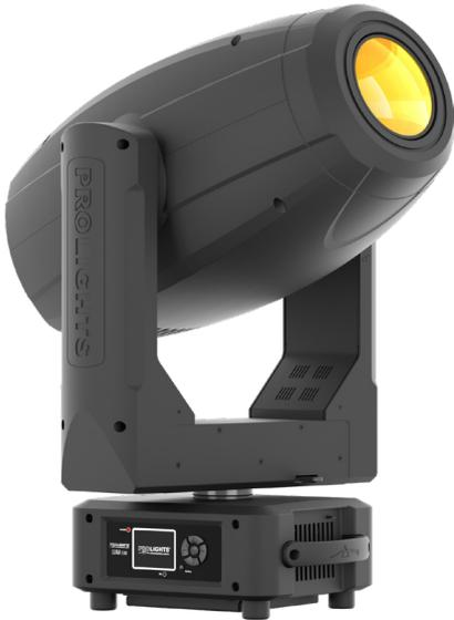
Luma 1500SH è un testa mobile sagomatore con sorgente a LED 440W 6.500K, progettato per sostituire un proiettore con lampada a scarica di 1.200W in teatri, concerti, eventi e televisione. Il suo sistema ottico offre una fascia luminoso preciso, una proiezione uniforme e una messa a fuoco nitida dei gobos grazie al suo ampio zoom lineare da 5° a 50°.
